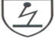
Topraklama Bağlantı Ucu ; Fırına dışarıdan çekilen topraklama kablosunun bağlanacağı ucu gösterir. **Topraklama Bağlantısı mutlaka yapılmalıdır.**
